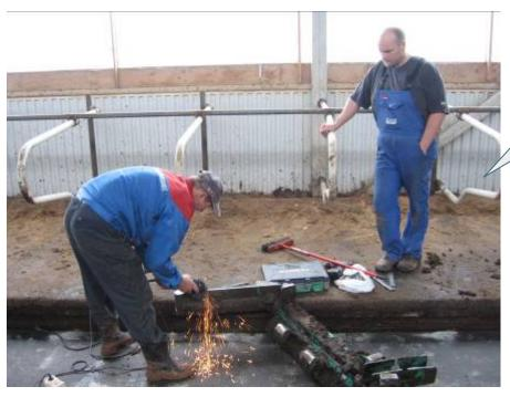
**Astuce**: retourner le racleur, contrôler les angles vifs et si nécessaire les arrondir avec une meuleuse.
