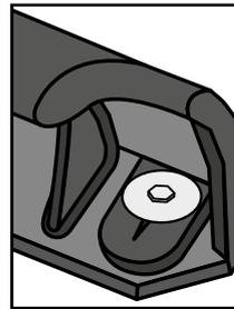
Visser la vis avec la rondelle jusqu'à ce qu'elle repose de façon uniforme.
