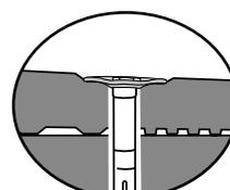
**i Astuce :** pour vérifier, racler avec un objet métallique plat (p. ex. un marteau) au-dessus de la fixation. Si vous sentez la fixation, enfoncer la fixation davantage !
