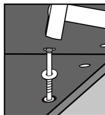
Frapper le clou-vis avec la rondelle jusqu'à ce qu'il repose de façon uniforme et légèrement enfoncé
