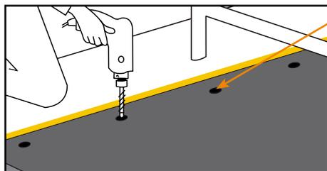
Fixer au bord avant à travers les points de fixation pré-marqués
