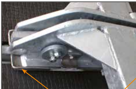
Appui large pour le bloc central, en forme de patin recourbé
