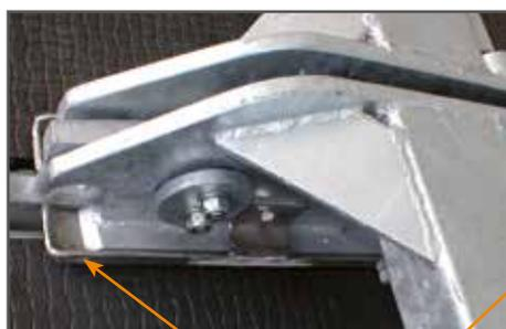
ampio appoggio per il blocco centrale, piegato in alto a forma di slitta all'estremità
