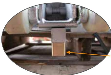
spessorare la guida del blocco centrale dello spessore dei tappeti
