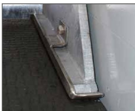
pattino laterale largo e piegato in alto a forma di slitta, avvitato
