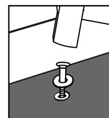
вбить гвоздь и подкладную шайбу, чтобы крепёж плотно «сидел» и немного был погружен
