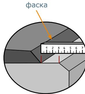
задний бетонный край стойла: расстояние мин. 3 см!
