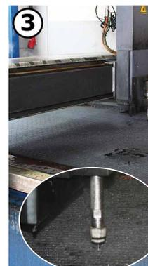
согласно подготовленным на заказ CAD-чертежам вырезаются щели в покрытии с помощью инновационной технологии-водной струй
