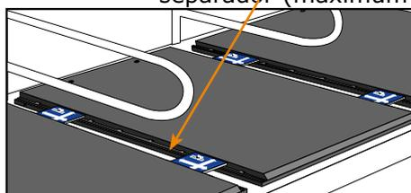
para la colocación suelta, ajustar la distancia entre colchón con la ayuda del útil (que es más ancho que el perfil)
