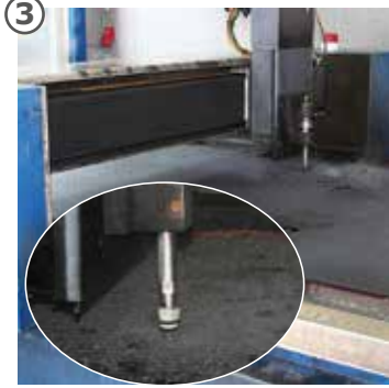
CAD tarafından yapılan çizimlere uygun olarak su jetleri ile kauçuk kesimleri yapilir
