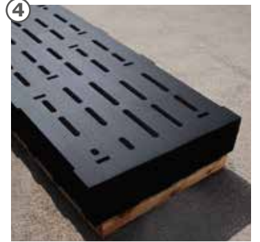
CAD tarafından yapılan çizimlere uygun olarak su jetleri ile kauçuk kesimleri yapilir
