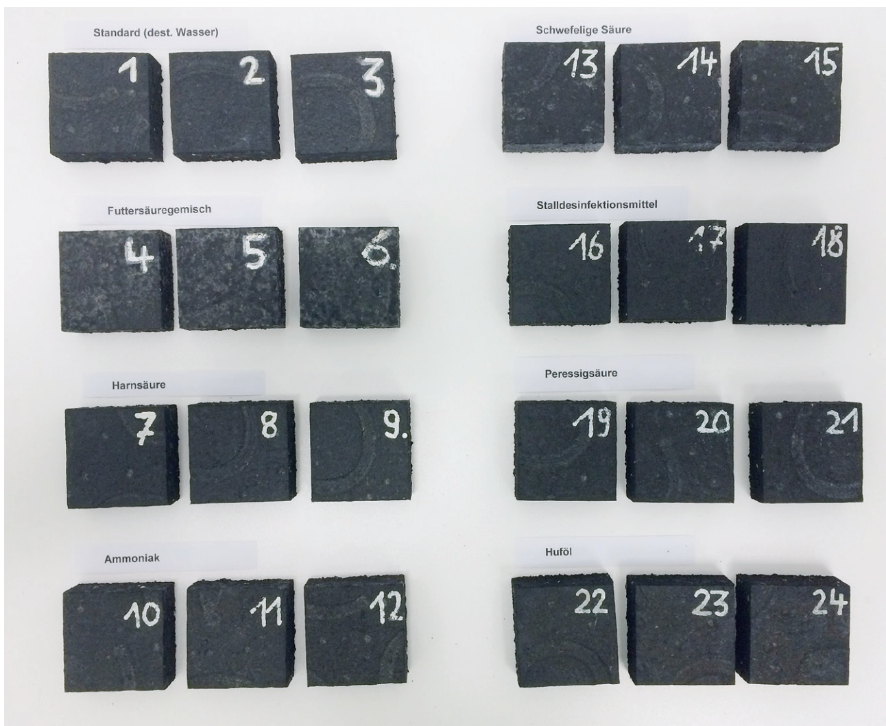
Bild 7: Prüfkörper nach dem Säurebeständigkeitstest
