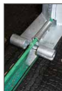
keskiohjurin leveä laakeri hitsattu rautatankoon
