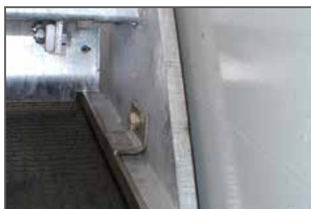
leveät ja taivutetut sivujalokset ruuvattuna
