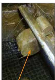
ohjurijalas pääraappaan kiinnitettynä
