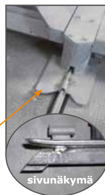
keskiohjurin leveä laakeri on taivutettu jalakseen muotoon
