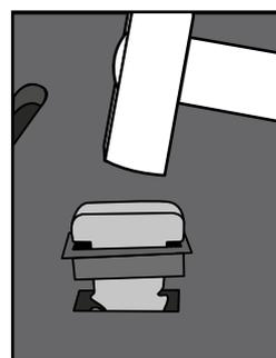
piantare l'elemento di fissaggio attraverso la cavità del tappeto nella feritoia
