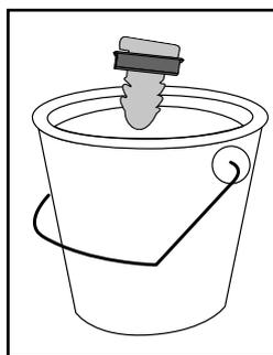
immergere l'elemento di fissaggio in acqua tiepida (lubrificazione)
