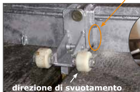
il blocco centrale si muove su larghi rulli di plastica
