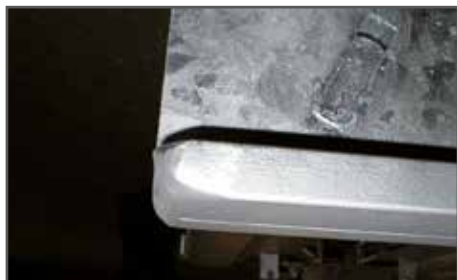
arrotondare la zona di appoggio dei pattini laterali
