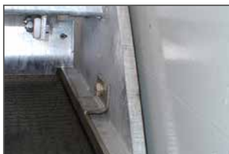
pattino laterale largo e piegato in alto a forma di slitta, avvitato
