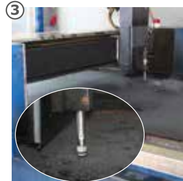
согласно подготовленным CAD-чертежам щели точно вырезаются в покрытии с помощью инновационной технологии водной струёй
